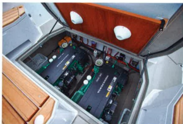
MEGET RYDDIG: De tekniske installasjonene er samvitthetsfullt utført i 33-foteren. Legg merke til den smarte oppbevaringen av bordet til akterdekket.
